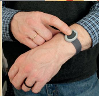
den. Der Funksender wird entweder als Halskette oder wie eine Uhr am Handgelenk getragen. Im Bedarfsfall genügt ein Knopfdruck auf den Funksender, und die Sendestation stellt die Verbindung zur Notrufzentrale her. Falls notwendig, werden die Bezugspersonen, die Angehörigen, der Hausarzt oder der Krankentransport verständigt, um Hilfe zu leisten.
