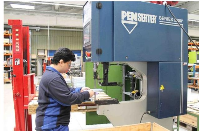
Einpressgerät für Bolzen und Muttern
