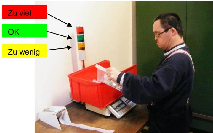
Mengenkontrolle mit Zählwaage
