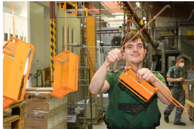
gepulverte Teile im Abkühlvorgang
